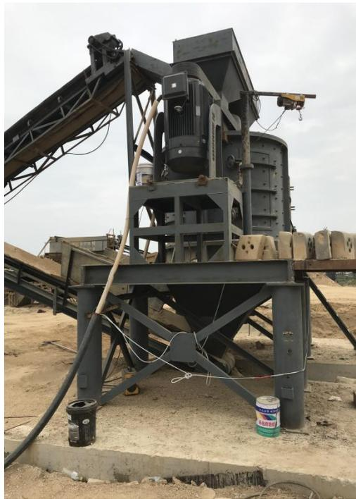
1)、先用 BVM-100-2D 做现场动平衡的初始测试。在转速为 630rpm 时:
