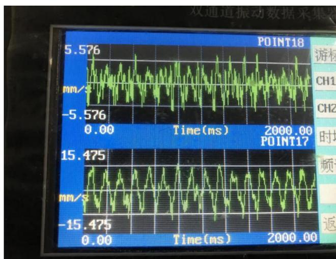
3) 平衡后在 730rpm 转速下轴承座频谱图:
